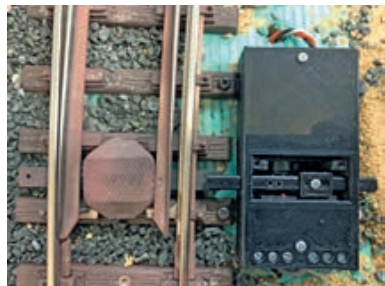
Die selbst gebauten Servo-Weichenantriebe in der Unterflurmontage.
