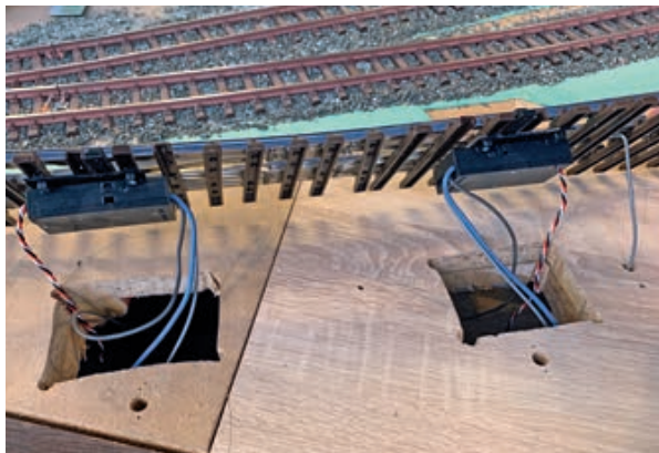
Die selbst gebauten Servo-Weichenantriebe in der Unterflurmontage.
