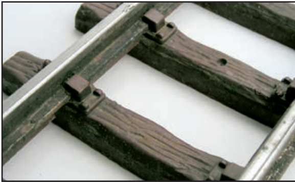
Ein 27 Jahre drau- ßen befahrenes vernickeltes Thiel- Gleis zeigt nur wenig Verschleiß.
