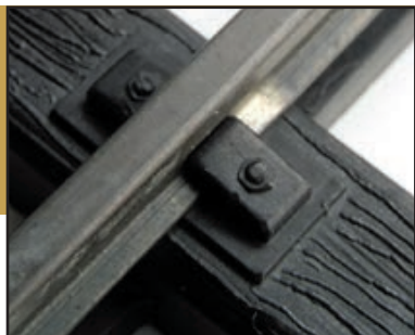
Neusilber oxidiert. So sahen Peco-Gleise nach einem Jahr im Freien aus. Rechts wurde das Profil mühsam geschliffen.
