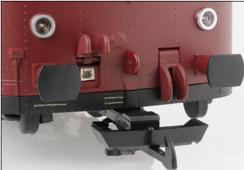
zuletzt: Der VS besitzt nur auf der Seite des Dienstabteils einen Endführerstand und daher nur auf dieser Fahrzeugseite das Dreilicht-Spitzensignal, während die andere, führerstandlose Fahrzeugseite nur mit zwei roten Schlussleuchten ausgerüstet ist. Für die Zugspitzenbeleuchtung sorgen weiße LEDs.
