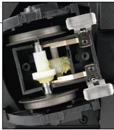
Neue, abgekantete Schienenschleifer unterstützen nicht nur die Stromabnahme am VT, sie führen auch die Lenkachsgestelle. Die Stromabnahme über die Räder des VT ist am besten, wenn auch die Achswelle blank ist, wobei man die Achsstromschleifer nach der Einfahrphase von überschüssigem Achslagerfett reinigen sollte. Am Steuerwagen sind die Schienenschleifer werkseitig ohne Stromfunktion, sie werden aber zur Seitenführung der Lenkachsen benötigt.
