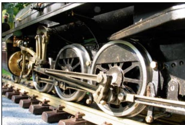
Die Treibachse der G 4/5 ist mit einer Klotzbremse ausgerüstet, die über einen Servoantrieb ferngesteuert wird. Um die Verbundlok zum Stehen zu bringen, werden je Treibrad zwei dünne Lederflecken auf die Radlaufflächen gepresst.
